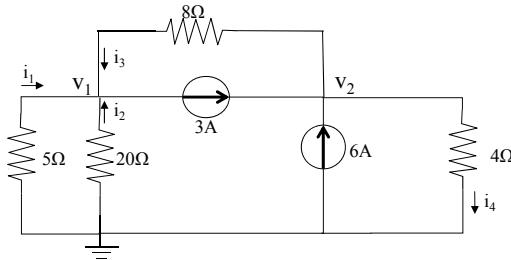
KCL at  $v_1$ :  $i_1 + i_2 + i_3 = 3$ ;
