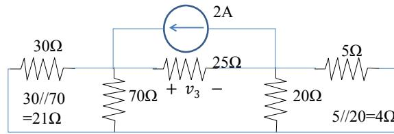
$$v_0 = v_1 + v_2 + v_3 = 14 - 8 + 25 V = 31V$$
