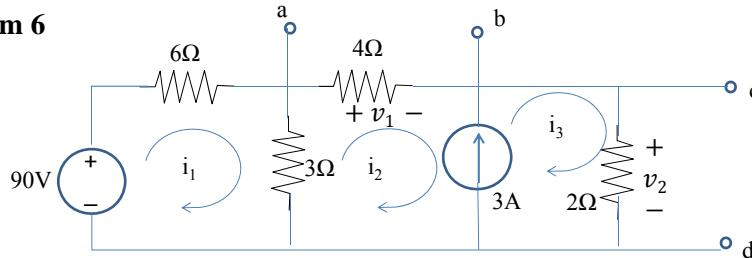
$$\begin{cases} 6i_1 + 3(i_1 - i_2) - 90 = 0 \\ 4i_2 + 2i_3 - 3(i_1 - i_2) = 0 \\ i_3 - i_2 = 3 \end{cases} \rightarrow \begin{cases} i_1 = 11A \\ i_2 = 3A \\ i_3 = 6A \end{cases} \quad \begin{aligned} V_{ab} &= v_1 = 4i_2 = 12V \\ V_{cd} &= v_2 = 2i_3 = 12V \end{aligned}$$
