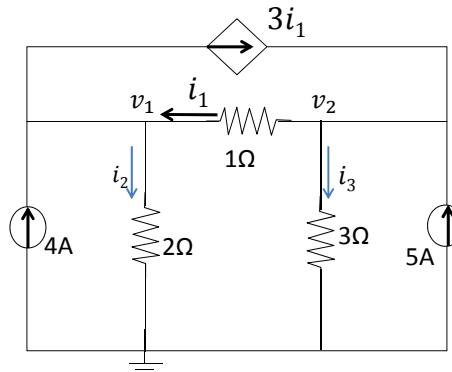
$$i_1 = v_2 - v_1 = -\frac{7}{9}A = -0.778A$$
