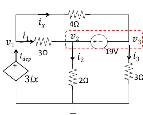
$$\begin{cases} \frac{v_1 - v_2}{3} - \frac{v_2}{2} - \frac{v_3}{3} + \frac{v_1 - v_3}{4} = 0 \\ v_2 - v_3 = 19 \\ v_1 = 3 \frac{v_1 - v_3}{4} \end{cases} \rightarrow \begin{cases} 7v_1 - 10v_2 - 7v_3 = 0 \\ v_2 - v_3 = 19 \\ v_1 + 3v_3 = 0 \end{cases} \rightarrow \boxed{\begin{cases} v_1 = 15V \\ v_2 = 14V \\ v_3 = -5V \end{cases}}$$
